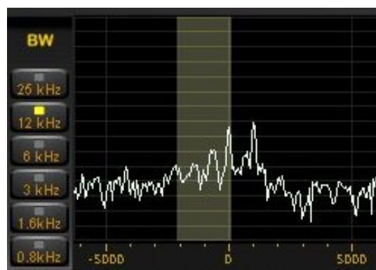
Fig. 10: Utilizzo del PBT per filtrare l'interferente.
