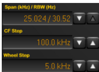
Fig. 6: Span, passo CF e passo rotellina mouse.
