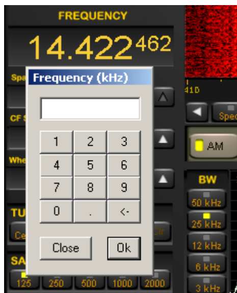
Fig. 5: Finestra di inserimento diretto della frequenza.
