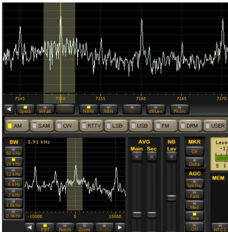
Fig. 11: Modalità spettro e pannello larghezza di banda.
