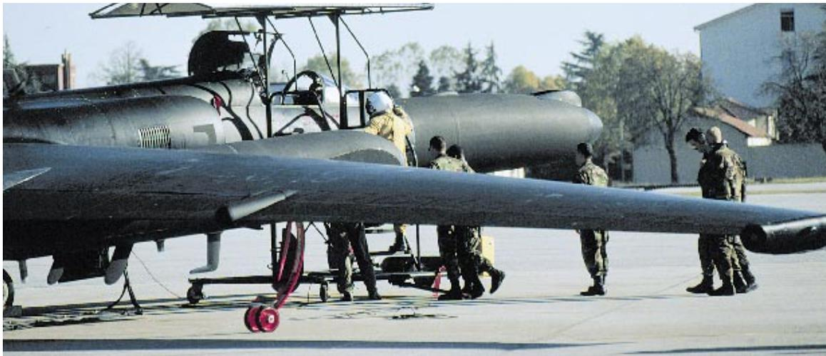
L'U-2S, infatti, è spinto da un turboreattore a doppio flusso General Electric F118-GE-101, una versione modificata dell'F101 montato sul bombardiere B-1 che equipaggia anche il B-2; a parità di spinta con il vecchio Pratt & Whitney J75 (che spingeva anche i caccia F-106) permette una diminuzione dei consumi del 15%, una maggiore affidabilità ed un risparmio di peso di quasi 600 kg che si traduce in una superiore tangenza operativa o in un aumento del carico utile.
