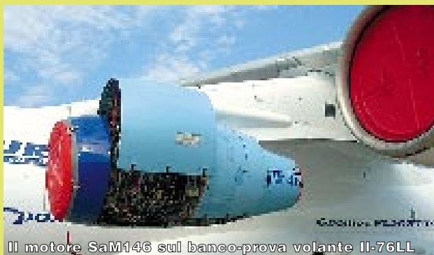
Il motore SaM146 sul banco-prova volante II-76LL
