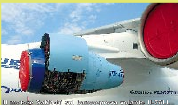
Il motore SaM146 sul banco-prova volante Il-76LL
