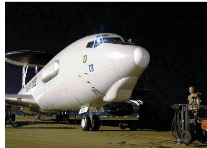
cambia secondo il tipo di missione da svolgere. Volando a 9.150 m ad una velocità media di 800 km/h, il radar di un E-3A può identificare aeromobili a bassa quota per un raggio utile di 400 km ed a media/alta quota fino a 520 km. Ha sotto controllo, quindi, una superficie pari a 312.000 kmq. Questi sono i dati ufficiali ma si ritiene che in realtà la copertura sia ben superiore.
